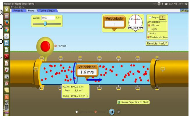
**Reinicie tudo.** Agora, tente deformar o tubo conforme a figura ao lado, apenas arrastando as alças inferior e superior presentes no tudo. Verifique com o velocímetro a velocidade do fluido na região indicado pelas setas preta na figura. **V<sub>1</sub>**: \_\_\_\_\_ **V<sub>2</sub>**: \_\_\_\_\_. Marque: marcador de fluxo, e verifique a área da secção na região indicado pelas setas pretas na figura. **A<sub>1</sub>**: \_\_\_\_\_ **A<sub>2</sub>**: \_\_\_\_\_.
