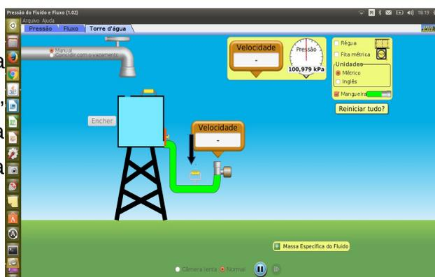
Agora, proceda conforme a figura do lado, colocando a mangueira na metade da altura suporte do tanque. Para isso, puxe a alça da mangueira para cima, indicada pela seta preta na figura. Observe o que ocorre. Qual a altura máxima do jato de água (use a régua). \_\_\_\_\_.
