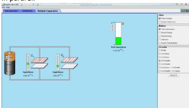
4. Lakukan perhitungan nilai kapasitas kapasitor pengganti Pararel untuk berbagai variasi nilai kapasitansi masing-masing kapasitor, dan sajikan data tersebut dalam excel.
